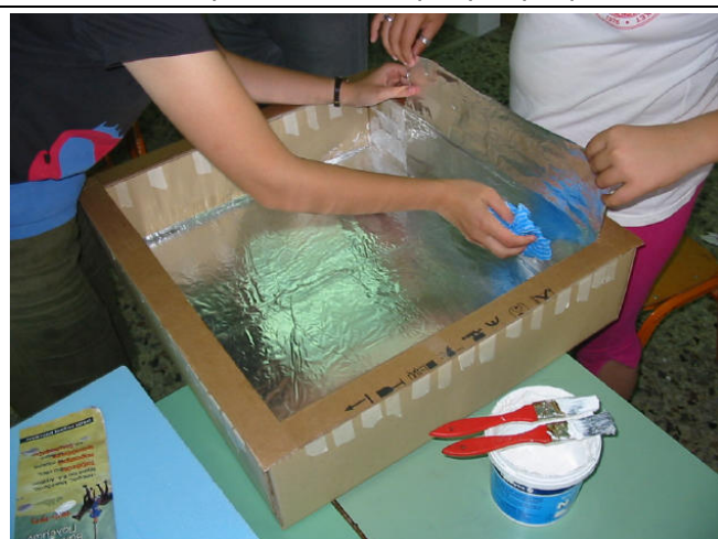
Φωτ. 6: Κολλάμε μέσα αλουμινόχαρτο και στα πλαίσια τοιχώματα της κούτας.
