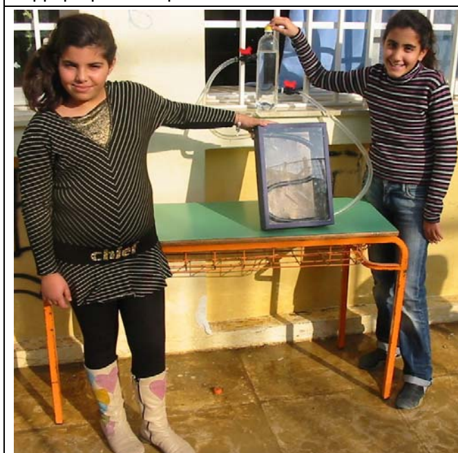
Φωτ. 1: Οι ηλιακοί συλλέκτες με το νερό και τα θερμομέτρα στον ήλιο.
